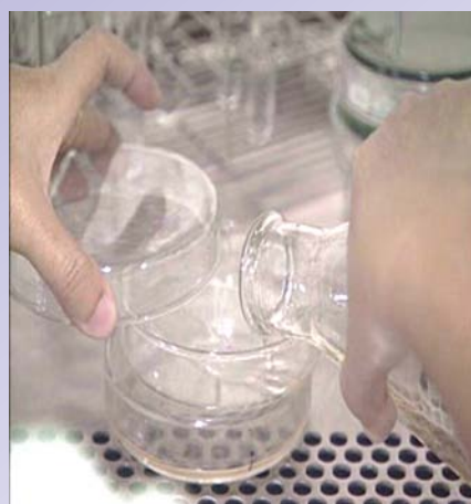
Pengujian parameter Angka Lempeng Total di Laboratorium Mikrobiologi PPOMN Badan POM
