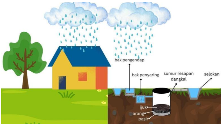
Gambar 7 Contoh gambar sumur resapan dangkal berbentuk bulat dengan menggunakan saluran terbuka
