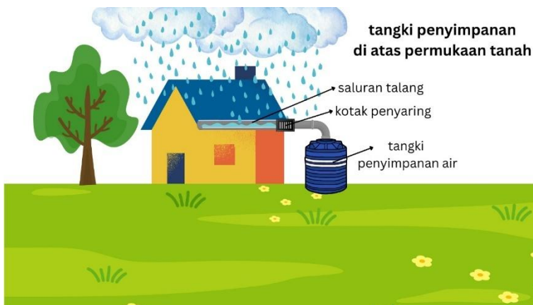
Gambar 4 Contoh tangki pengumpulan air hujan di atas permukaan tanah
