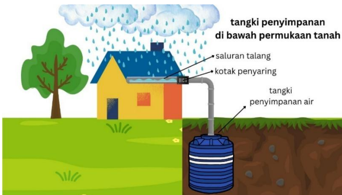
Gambar 5 Contoh tangki pengumpulan air hujan di bawah permukaan tanah
